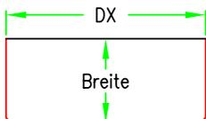
Zuschnittlänge =  $L - 2 \cdot B + 2 \cdot 25\text{mm} + 20\text{mm}$  (Zugabe)
