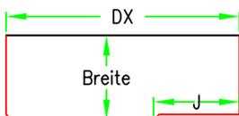
Zuschnittlänge =  $L - B + 25\text{mm} + 20\text{mm}$  (Zugabe)
